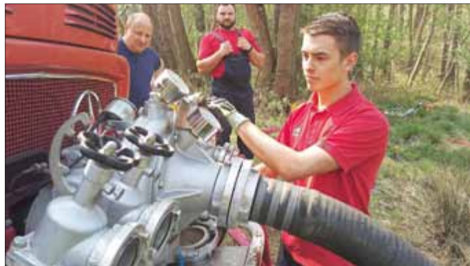
Gerhard Bierschenk bedient unter Anleitung von Kreisausbilder Helmut Langlott die Frontpumpe eines Löschfahrzeugs
